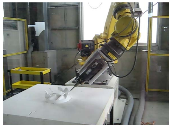
産業用ロボットでの切削加工風景
