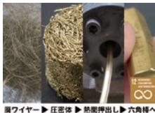
黄銅ワイヤー ▶ 圧密体 ▶ 熱戻り出し ▶ 六角棒へ
