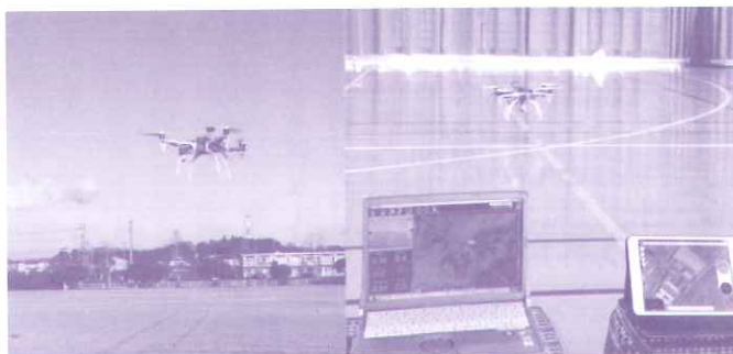
(a)校庭での自律制御飛行実験 (b)体育館での自己位置推定実験
