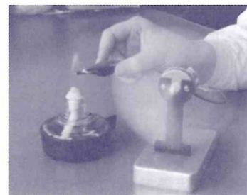
図 2 熱電発電素子による発電のデモ
