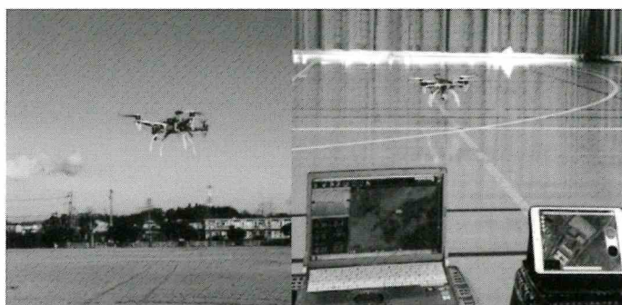
(a)校庭での自律制御飛行実験 (b)体育館での自己位置推定実験
