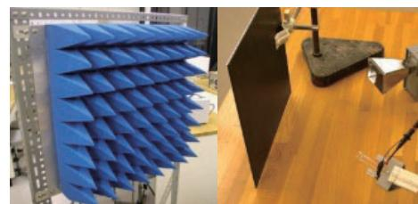
図 2 電波吸収体を用いた電磁波実験
