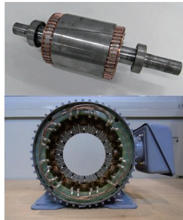
製作・試験した液体水素ポンプ駆動用超伝導モータ
