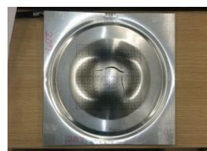
破断時の試験片
